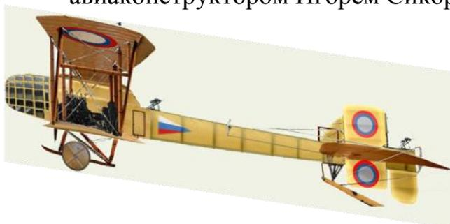
Размах крыльев: верхнего – 30,87 м, нижнего – 22,0 м; полетный вес – 5100 кг; максимальная скорость у земли – 110 км/час;
